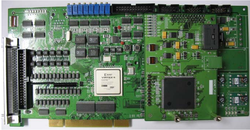
圖十四 IMC 運動控制卡全貌
