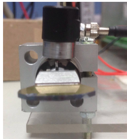
圖 6 振鏡馬達裝設鏡片實驗設置，螺絲固定於壓克力板。
