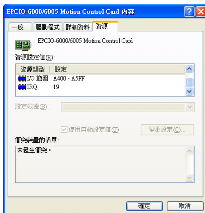
圖六 EPCIO Series Motion Card 系統資源分配實例
