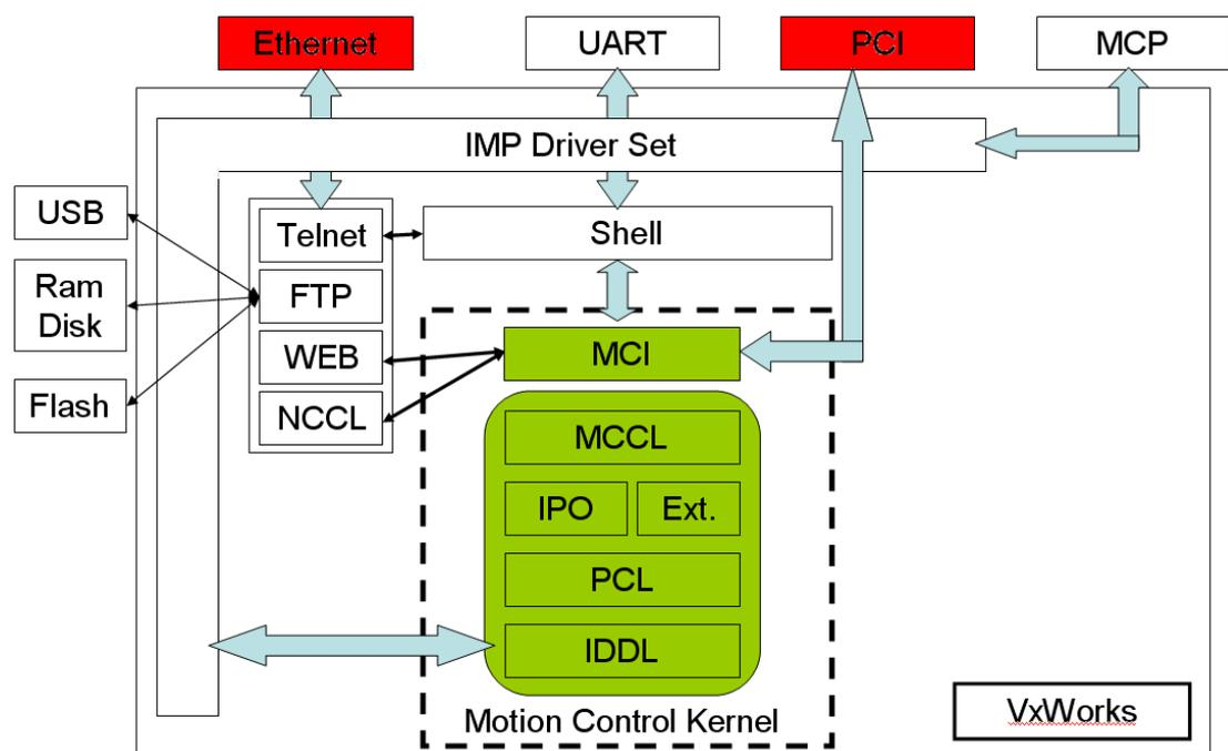
圖二 IMP\_A<sup>+</sup> PC運動控制平台架構方塊圖
