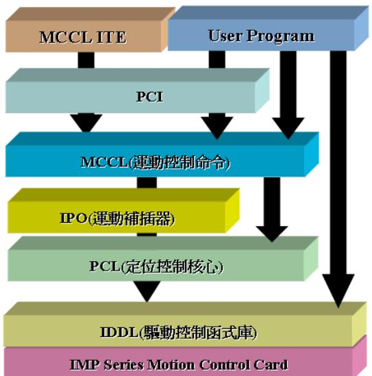
圖四 IMP\_A<sup>+</sup> PC\_PCI Based型運動控制模式
