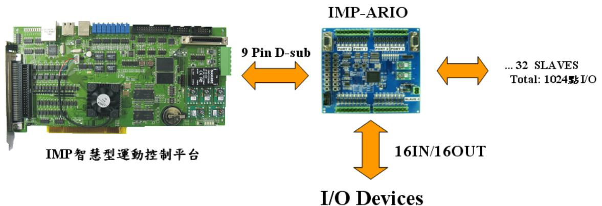
圖九 非同步串列遠端 IO
