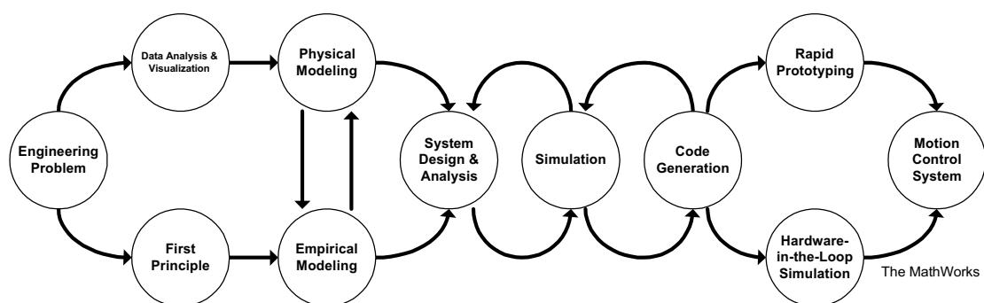
爲了滿足上述各階段的需求，經整合的新一代運動控制系統設計環境需包括資料分析、資料視覺化、演算法設計、模型模擬、產生程式碼等工具，這些工具依照功能的不同可區分爲四類，包括了：
