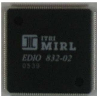
圖 2 EDIO ASIC-數位輸出入控制晶片
